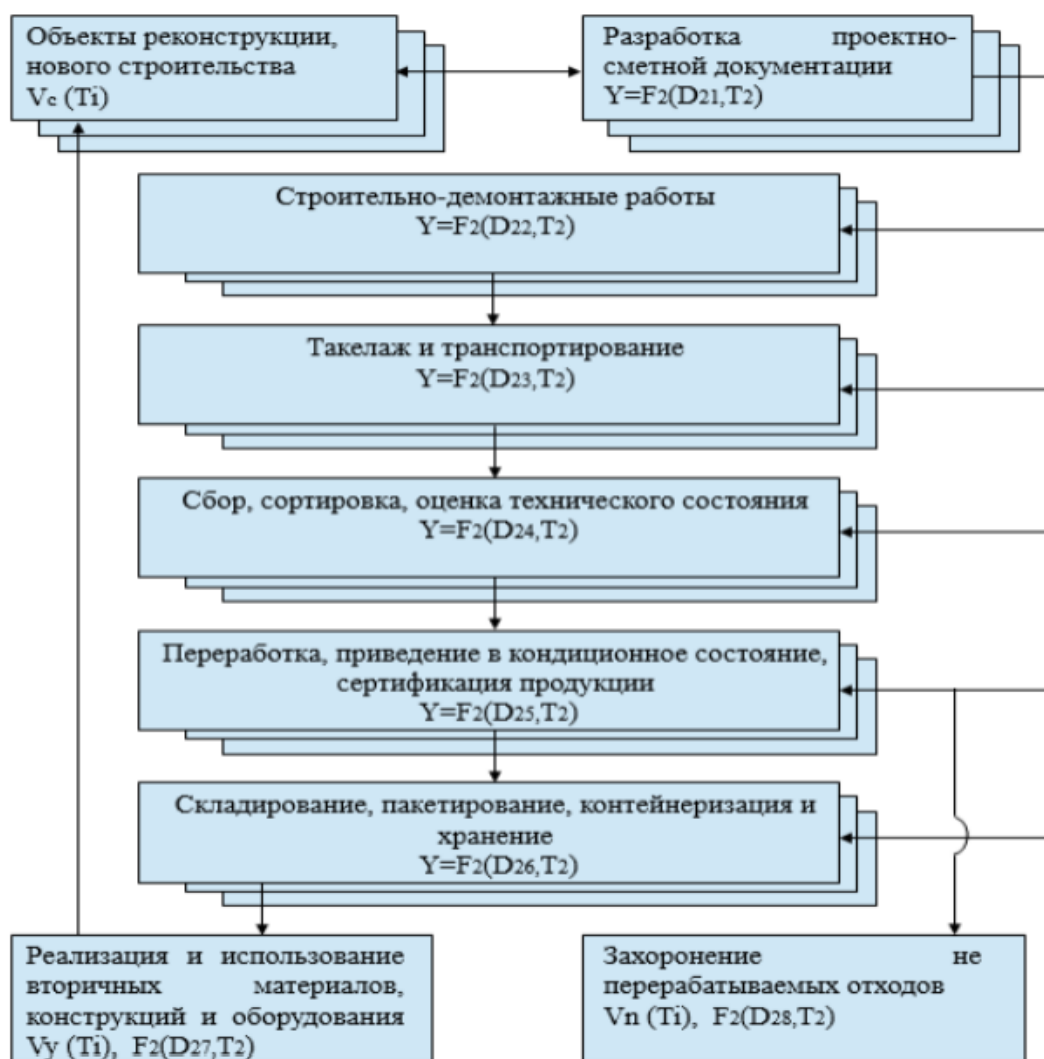
Рис. 1. Этапы комплексного использования вторичных строительных ресурсов
