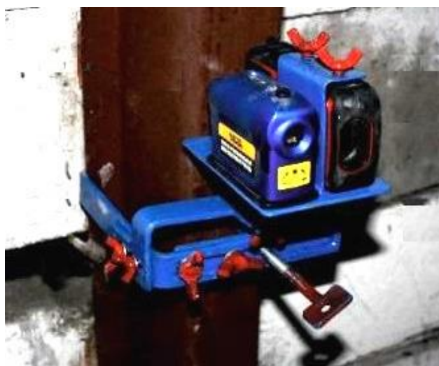
Рис. 5. Установка измерительного устройства на стойке металлической крепи
