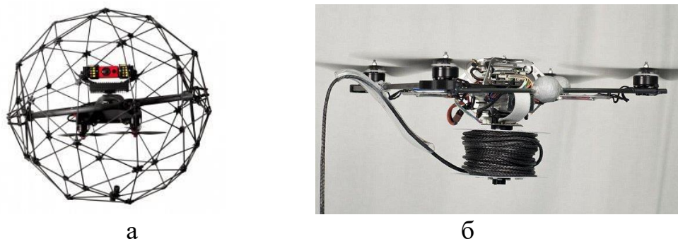
Рис. 2. Примеры БПЛА: а – в защитном корпусе; б – управляемый через оптоволоконный кабель
